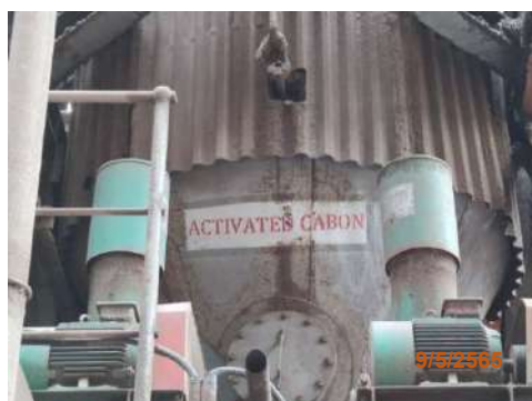
รูปที่ 2-11 ระบบฉีดถ่านกัมมันต์ (Activated Carbon)
